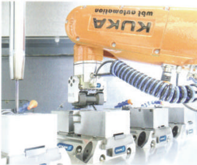
Bei WBT Automation wurde in eine Standard-Einzelplatzmaschine ein „KR Agilus WP“-Roboter im Zerspanungs-geschehen platziert.
